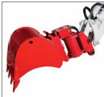
Powerlift con enganche rápido hidráulico y cazo montado al revés
