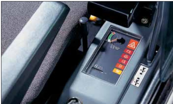
Display con avisos acústicos y visuales en caso de fallo durante el funcionamiento.
