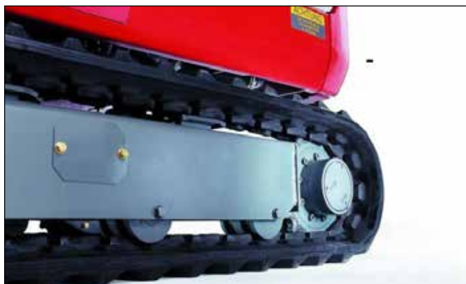
Rodillos con doble guía para un óptimo y seguro funcionamiento de las cadenas de goma Double-Short-Pitch para evitar la vibración.
