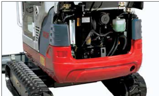
Motor con niveles reducidos de ruidos y emisiones de gases, compartimiento espacioso del motor, tubo de escape hacia arriba, contrapesos macizos.
