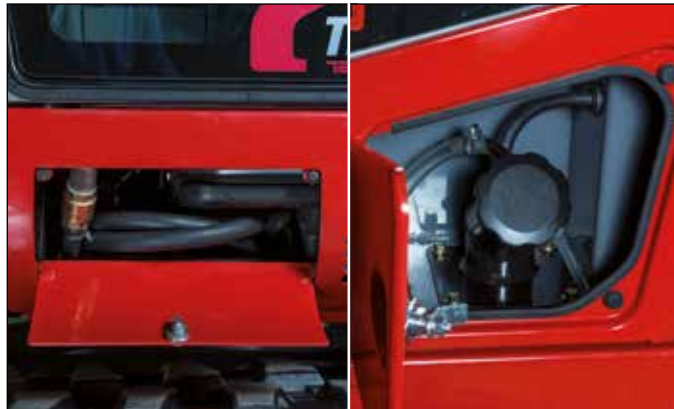
Tapa de registro adicional para un acceso óptimo a la bomba de repostar y la tapa del depósito de gasoil.
