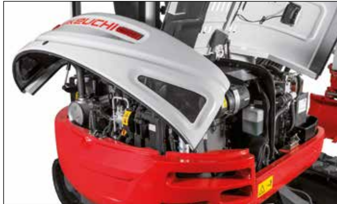
Amplias tapas de registro para facilitar el mantenimiento y un acceso cómodo a los componentes hidráulicos y al motor.
