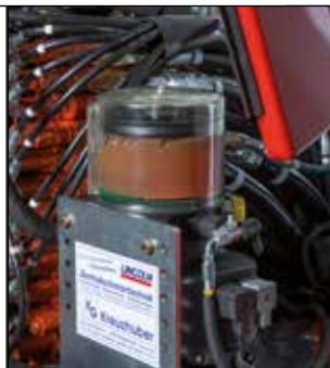
Engrase centralizado con indicador de vacío
