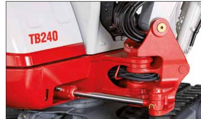
Bloque de giro robusto con cilindro de giro del brazo, latiguillos colocados de manera protegida.
