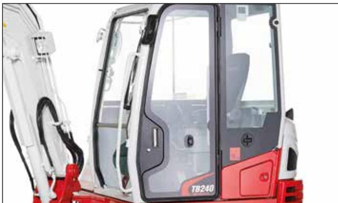
Amplia cabina insonorizada, pobre en vibraciones, con compartimentos de almacenaje, entrada amplia con fijación masiva de puerta y cristal frontal abatible.
