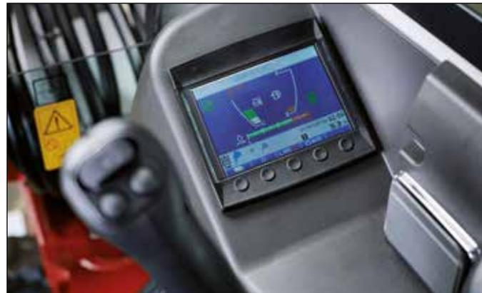
Display con elementos de control visuales y acústicos. Modo ECO para aumentar la rentabilidad y disminuir el consumo de gasoil.
