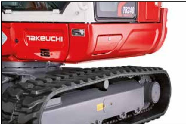
Rodillos con guía interior y exterior para un funcionamiento seguro de las cadenas de goma Double-Short-Pitch que evitan vibraciones durante la marcha.
