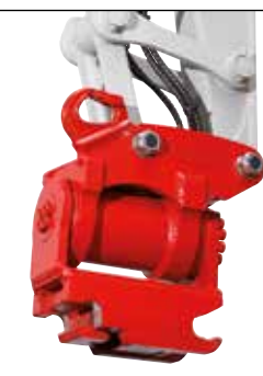
Implemento giratorio HUPPTilt con enganche rápido hidráulico HUPPPlate H
