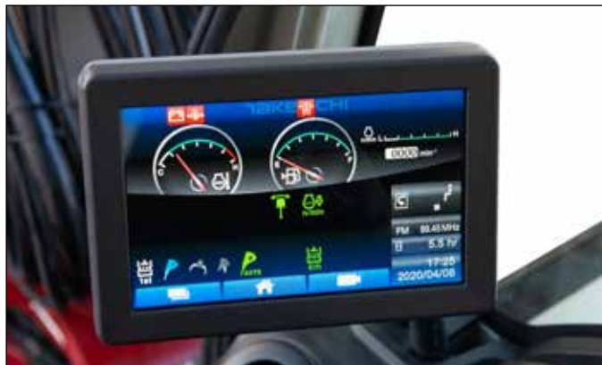
Nuevo display táctil de 8" multifuncional con nuevas funciones, resistente a rayaduras, vidrio laminado antivaho. Visualización automática de la cámara trasera.
