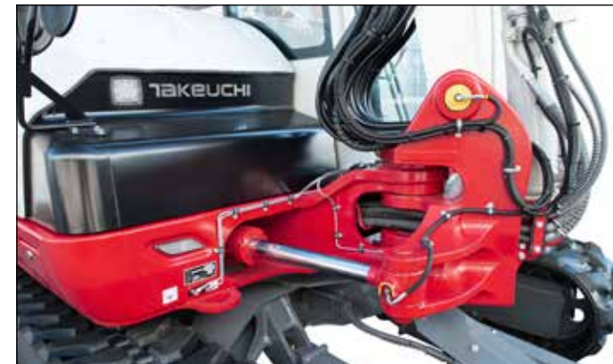
Robusto bloque de giro. Amortiguación en el final de carrera en cilindros de elevación, balancín y giro de brazo. Aviso de sobrecarga y válvula de seguridad anticaída.
