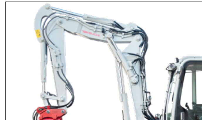
4 circuitos hidráulicos, 3 de ellos dirigidos por potenciómetros, caudal regulable. La TB370 está disponible también con brazo articulado.
