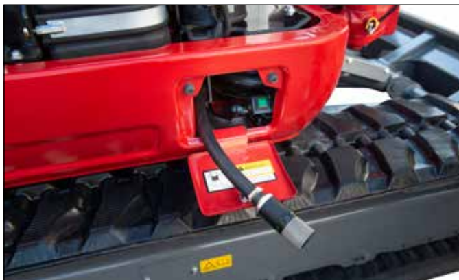
Tapa abatible adicional para un acceso óptimo a la bomba de repostar, con manguera de succión retráctil.
