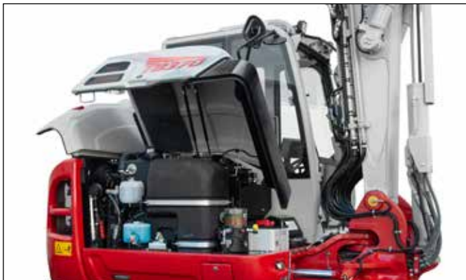
Motor con niveles reducidos de consumo, ruidos y emisiones de gases. Filtro de partículas con autoregeneración.
