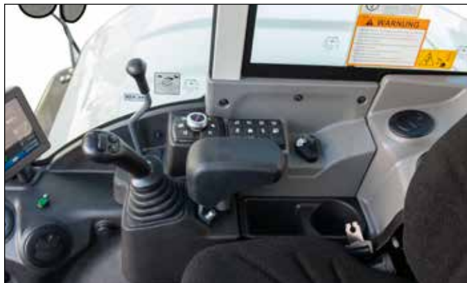
Dirección proporcional de la hidráulica auxiliar desde el joystick izquierdo y derecho. Innovador mando selector 3D para más confort.
