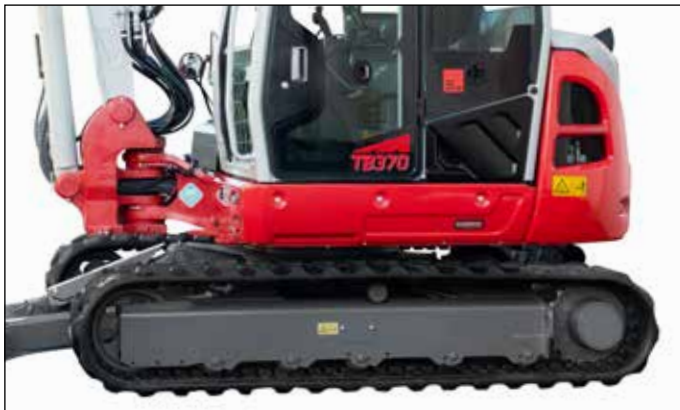
Rodillos con guía interior y exterior para un funcionamiento seguro de las cadenas de goma Double-Short-Pitch para una marcha baja en vibraciones.
