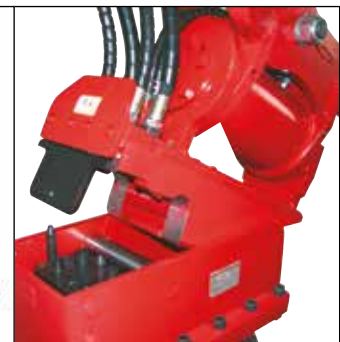
Sistema Huppi-Quick: conexiones hidráulicas se conectan automáticamente durante la fase de acoplamiento
