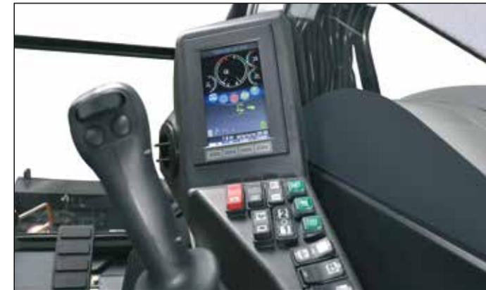
Display con elementos de control visuales y acústicos. Modo ECO de serie, con tecla modo Power para aumentar la potencia.
