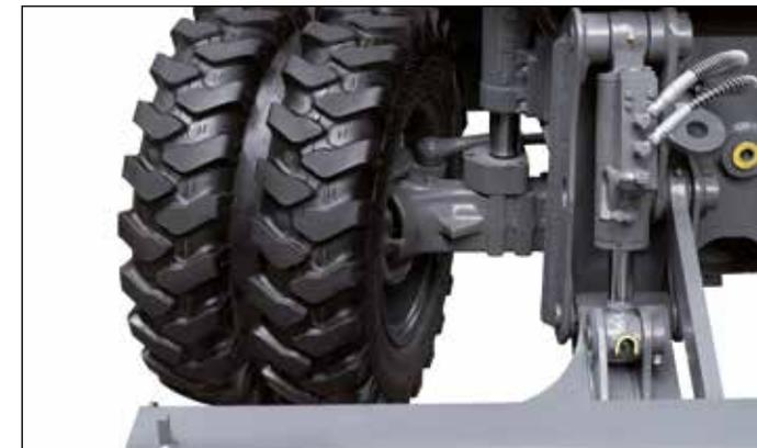
Calidad: Ejes de Dana Spicer. El eje de dirección es un eje oscilante con bloqueo automático. 8 neumáticos.
