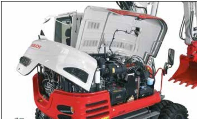
Amplias tapas de registro para un acceso cómodo a los componentes hidráulicos y al motor.
