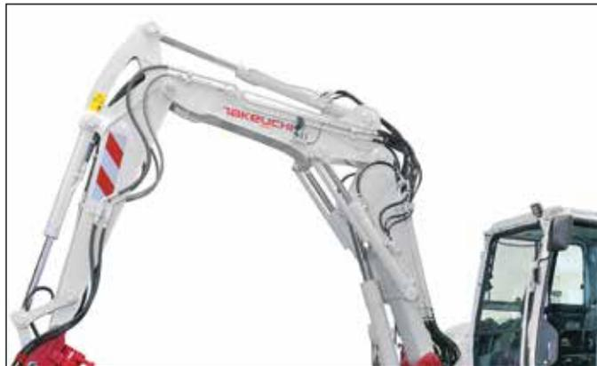
Brazo articulado con 4 circuitos auxiliares, 3 de ellos dirigidos por potenciómetros, caudal ajustable.
