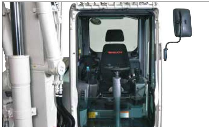
Asiento ergonómico con suspensión neumática y calefacción, elementos de mando colocados de manera óptima para trabajar sin cansancio.
