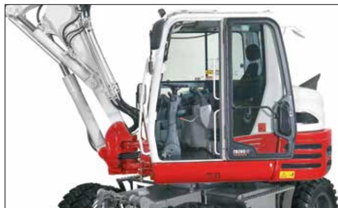
Amplia cabina insonorizada, pobre en vibraciones con compartimentos de almacenaje. Ajuste innovador del árbol de dirección para subir y bajar cómodamente de la cabina.
