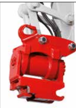
PowerTilt con enganche rápido hidráulico
