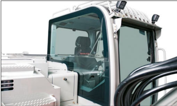
Cristal lateral tintado, evita reflejos y deslumbramientos.
