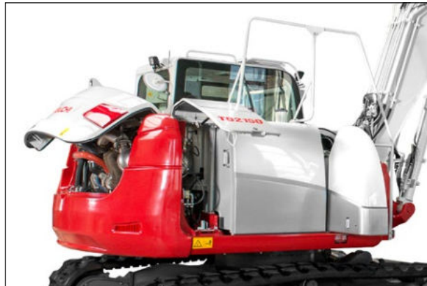
Contrapeso lateralmente subido y chapas de acero proveen a la máquina de una cubierta robusta sin restar comodidad para el servicio técnico.
