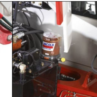
Engrase centralizado con dosificación automática con indicador de nivel
