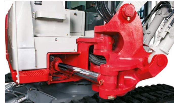
Bloque de giro robusto con latiguillos protegidos y giro de brazo hidráulico.
