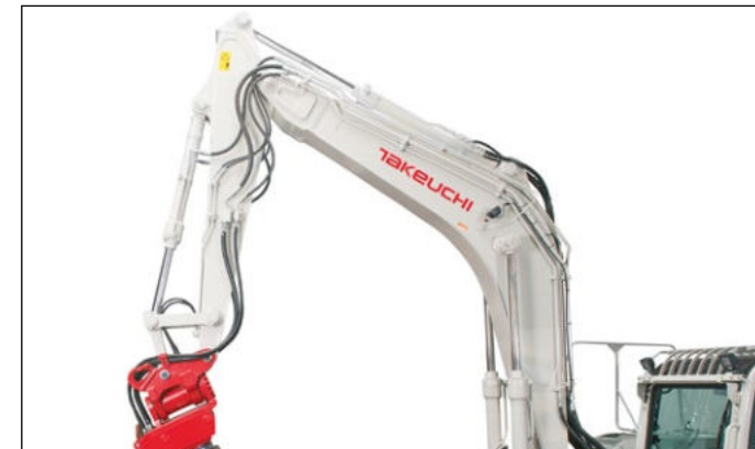
4 circuitos auxiliares, 3 de ellos dirigidos por potenciómetros, presiones y caudales regulables.
