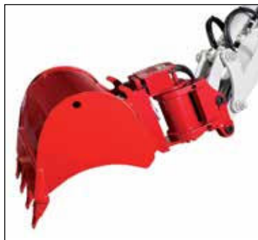
Powerlift con enganche hidráulico y cazo montado al revés
