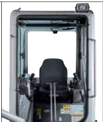
Techo de protección ROPS (ISO12117-2), TOPS (ISO12117), OPG (ISO10262 nivel 1), asiento de confort (versión: resistente a la intemperie) con cinturón de seguridad.
