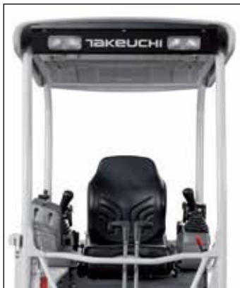
Techo de protección ROPS (ISO12117-2), TOPS (ISO12117), OPG (ISO10262 nivel 1), asiento de confort (versión: resistente a la intemperie) con cinturón de seguridad.
