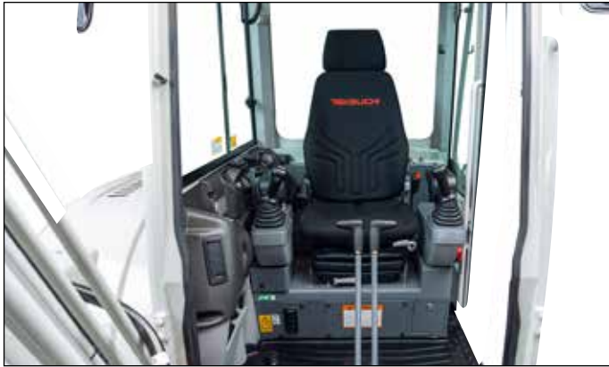
Asiento ergonómico amortiguado por aire con elementos de mando colocados de manera óptima para trabajar sin cansancio.
