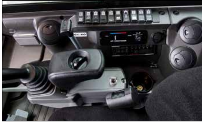
Dirección proporcional de la hidráulica auxiliar desde el joystick izquierdo y derecho.
