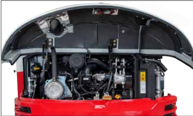
Motor con niveles reducidos de emisiones de gases y ruidos, amplio compartimento del motor, tubo de escape hacia arriba; contrapeso masivo.
