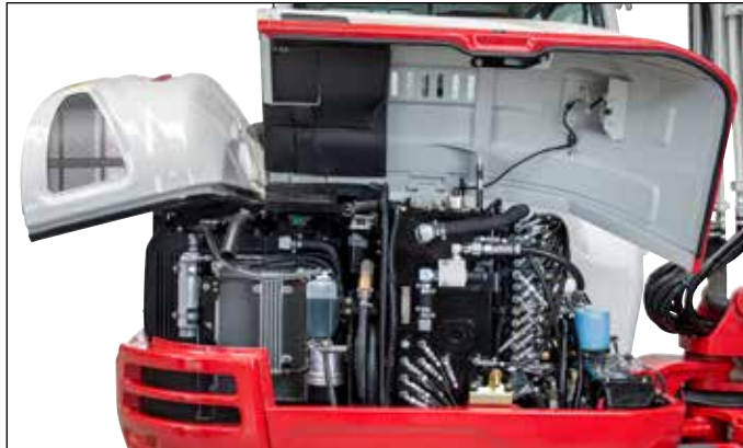
Amplias tapas de registro para facilitar el mantenimiento, acceso cómodo a los componentes hidráulicos, al motor y la bomba de repostar.
