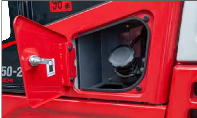
Tapa de registro adicional para acceso óptimo a la tapa del depósito de gasoil.
