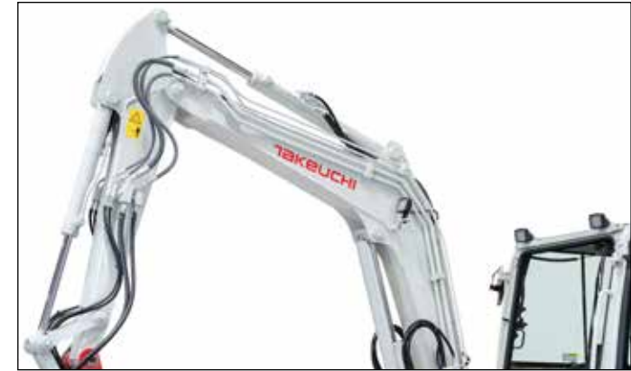
4 circuitos hidráulicos, 3 de ellos dirigidos por potenciómetros para una multitud de accesorios.
