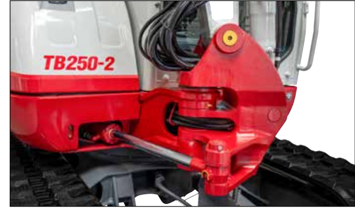
Bloque de giro robusto con latiguillos colocados de manera protegida, cilindro de giro del brazo con casquillos en todas las posiciones.
